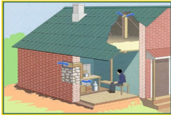
Şəkil 6.15. Radiasiya əleyhinə daldalanacaq kimi bina-nın daxilində uyğunlaşdırılmış yer
