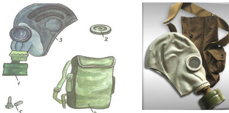
1-süzücü-uducu qutu; 2- tərləməyən plyonkalar olan qutu; 3- üzlük hissəsi (şlem-masqa); 4-çanta; 5- karandaş.
