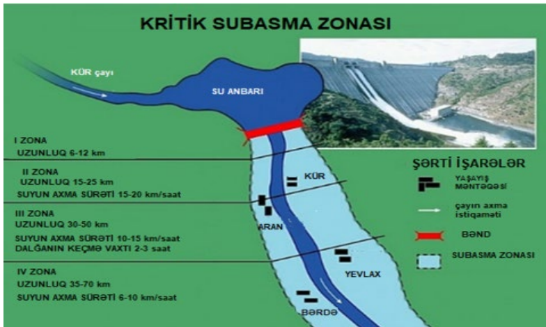
Şəkil 2.32. Kritik subasmanın sxemi
