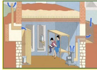
Şəkil 6.16. Radiasiya əleyhinə daldalanacaq kimi uyğunlaşdırılmış birmərtəbəli binanın zirzəmisini
