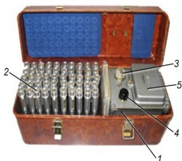
Şəkil 4.14. DP-22V ümumqoşun dozimetrlər dəsti
