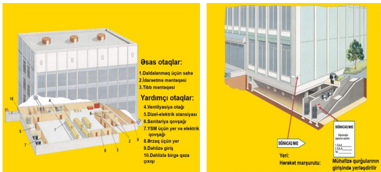
Şəkil 6.2. Sənaye müəssisələrinin yeraltı mərtəbələrində hazırlanmış mühafizə qurğusu
